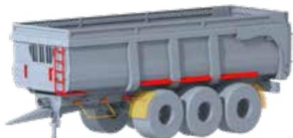
Откидная лестница из алюминия, оцинкованные грязезащитные крылья и возможность установки дополнительного оборудования (противоподкатное устройство и термопластичные грязезащитные крылья).
