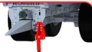
**Гидравлическая откидная опора** крепится непосредственно к шасси прицепа-самосвала для освобождения дышла и облегчения маневрирования.
